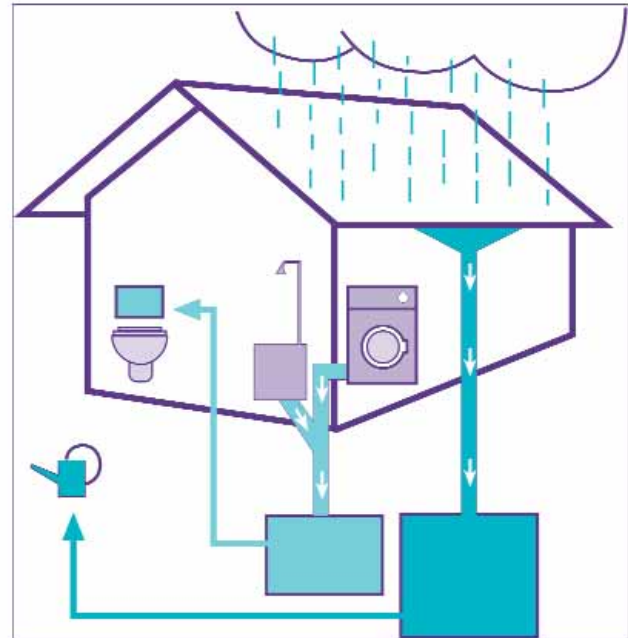
Figura 3- Reutilització d'aigües pluvials i aigües grises
